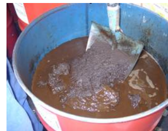
Entsorgung von Slops im 200-Liter-Deckelfass
