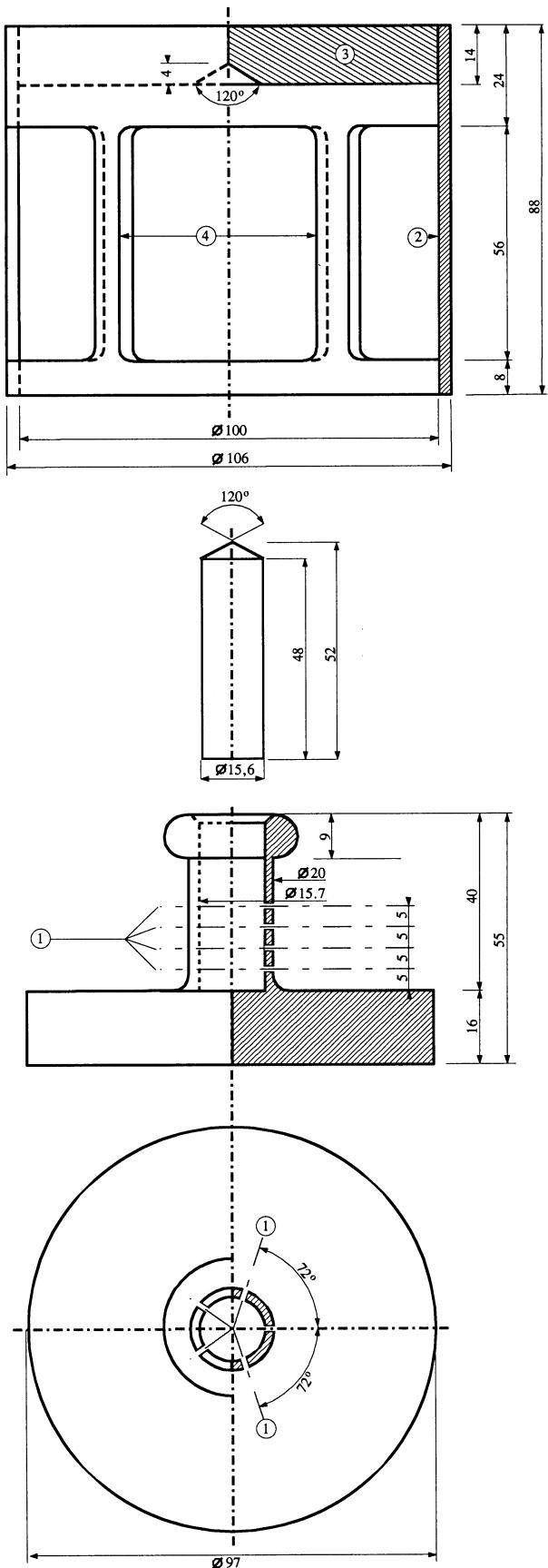
Рис.1. Колоколообразный груз массой 2220 г, который может подвешиваться к бронзовому поршню
