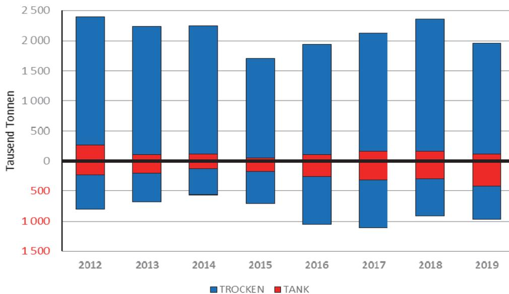
Abb. 8: Transportaufkommen mit Schubverbänden an der Schleuse GABČIKOVO im Berg- und Talverkehr auf der Donau pro Jahr in Tausend Tonnen
