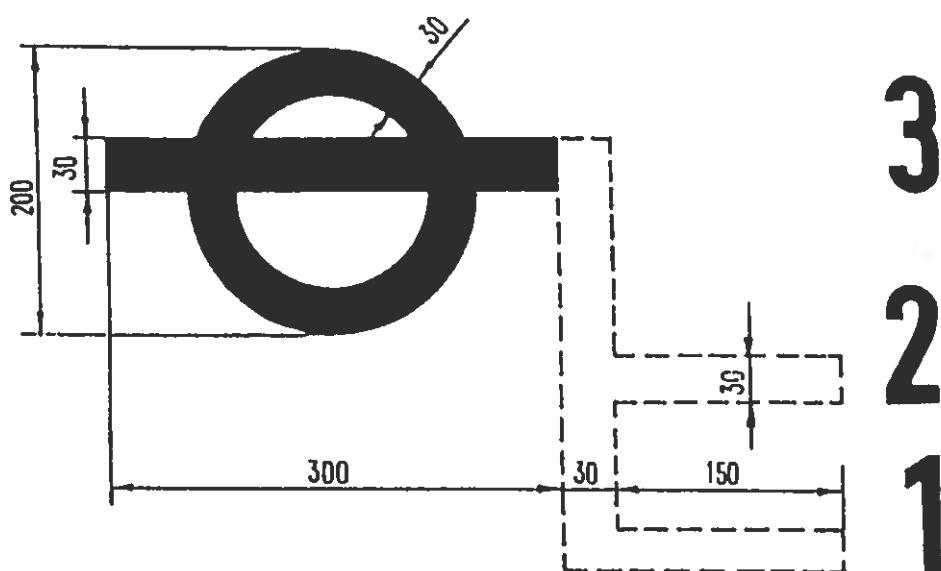
Изображение грузовой марки для различных зон плавания:
