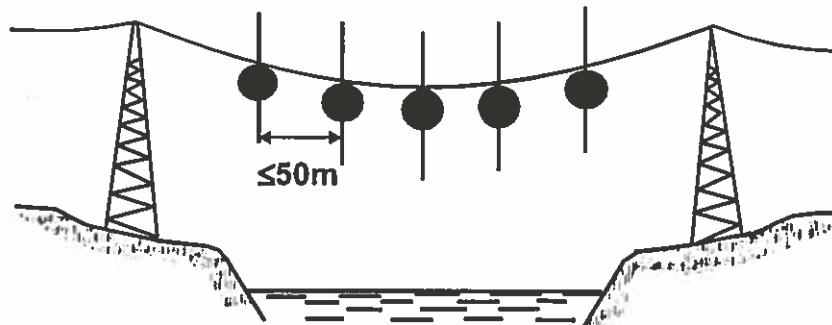
2. Радиолокационные отражатели, помещаемые на желтые буи, устанавливаемые в случае необходимости парами у каждого берега (каждая пара дает радиолокационное изображение в виде двух расположенных рядом точек, обозначающих воздушную линию электропередач).
