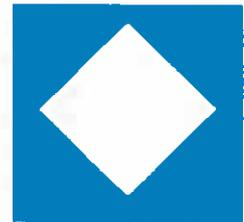
Е.5.11 - Зона стоянки, отведенная для экипажных и безэкипажных судов, поднимающих днем синий конус в соответствии со статьей 3.37
