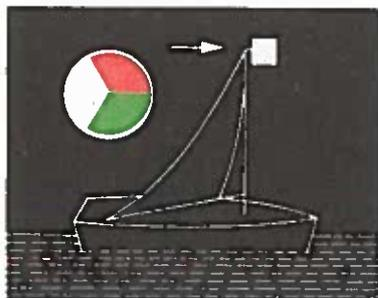
Бортовые огни, которые могут быть обыкновенными, а не яркими, и кормовой огонь, объединенные в одном фонаре, установленном на вершине или в верхней части мачты,
