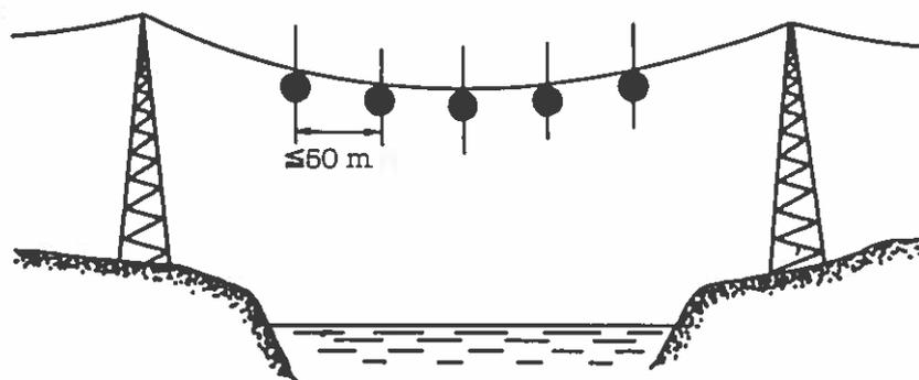
2. Радиолокационные отражатели, помещаемые на желтые буй, устанавливаемые в случае необходимости парами у каждого берега (каждая пара дает радиолокационное изображение в виде двух расположенных рядом точек, обозначающих воздушную линию электропередачи).
