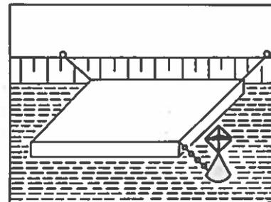
Желтый поплавок с радиолокационным отражателем
