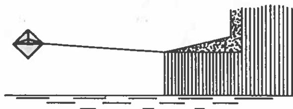
**Д.2. Обозначение воздушных линий электропередач.**
