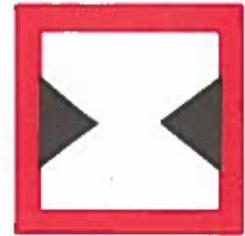
Примечание: На сигнальных знаках С.1, С.2 и С.3 могут быть также нанесены цифры, указывающие в метрах соответственно глубину, свободную высоту над уровнем воды и ширину фарватера или прохода.
