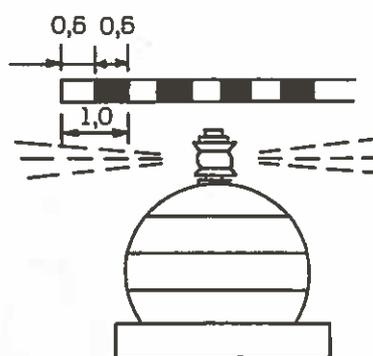
Сигнальные знаки А.3 служат для обозначения мест разъединения или соединения фарватеров, а также ограждают отдельно расположенные навигационные препятствия в границах фарватера. Суда, идущие как вниз, так и вверх по течению реки, могут оставлять знаки с любого борта.
