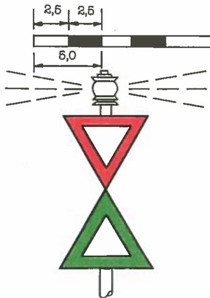
Сигнальный знак С.3 устанавливается на концах островов в пункте, где остров разделяет русло на два судоходных рукава, а также на берегу в устьях каналов и судоходных притоков.
