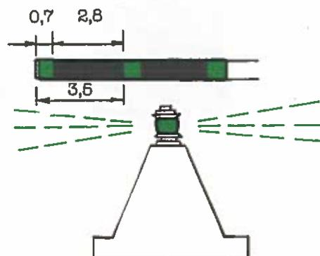
Сигнальные знаки А.2 служат для обозначения границ фарватера, а также для указания направления; они ограждают левую сторону фарватера и опасности левого берега реки.
