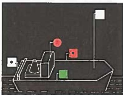
На одиночных моторных судах, несущих сигнализацию, предусмотренную в статье 3.09, устанавливается дополнительно один ясный красный огонь в их кормовой части
