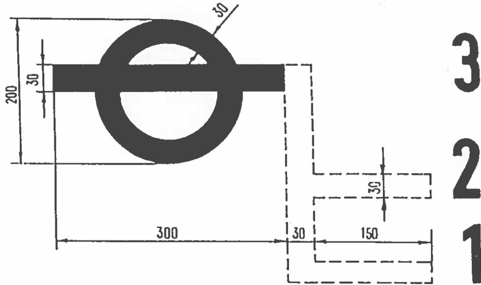
Изображение грузовой марки для различных зон плавания:
