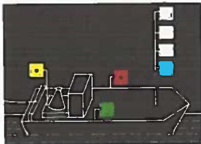
Обыкновенный синий огонь, видимый по той же дуге горизонта, что и топовые огни, предписанные в статье 3.09 п.2 и помещаемый на расстоянии около 1 метра под самым нижним из этих огней и, по мере возможности, на расстоянии 1 метра над бортовыми огнями
