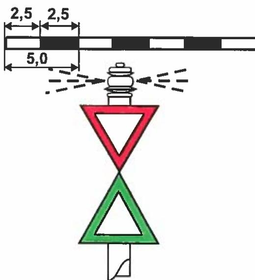
Сигнальный знак С.3 устанавливается на концах островов в пункте, где остров разделяет русло на два судоходных рукава, а также на берегу в устьях каналов и судоходных притоков.
