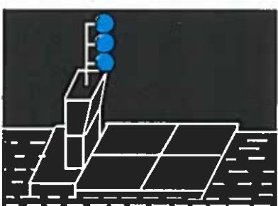
В зависимости от степени опасности груза: один, два или три обычных синих огня, видимых со всех сторон
