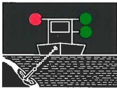
Со стороны, с которой фарватер свободен, два обычных или два ясных зеленых огня, расположенных один над другим и видимых со всех сторон, и в соответствующих случаях со стороны, с которой фарватер несвободен, обычный или ясный красный огонь, видимые со всех сторон
