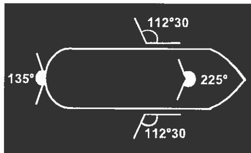
1.4.1. термин “**топовый огонь**” означает яркий белый огонь, излучающий непрерывный свет по всей дуге горизонта в  $225^\circ$  и расположенный таким образом, чтобы этот свет был виден с направления прямо по носу судна до  $22^\circ 30'$  позади траверза каждого борта,
