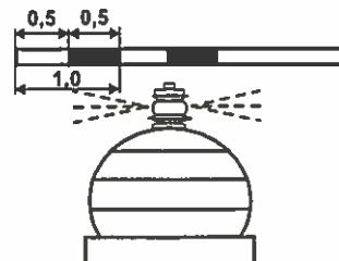
Сигнальные знаки А.3 служат для обозначения мест разъединения или соединения фарватеров, а также ограждают отдельно расположенные навигационные препятствия в границах фарватера. Суда, идущие как вниз, так и вверх по течению реки, могут оставлять знаки с любого борта.
