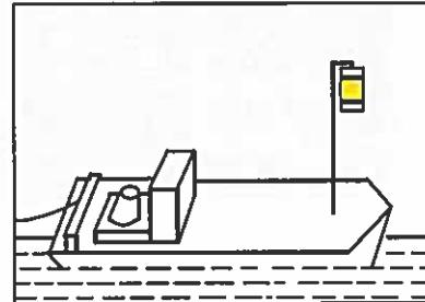
Желтый цилиндр с двумя полосами (черной и белой) как в верхней, так и в нижней части, причем белые полосы должны быть нанесены по краю цилиндра
