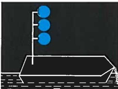
В зависимости от степени опасности груза: один, два или три обычновенных синих огня, видимых со всех сторон
