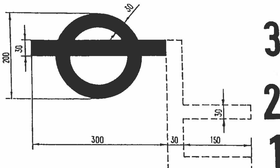
Изображение грузовой марки для различных зон плавания:
