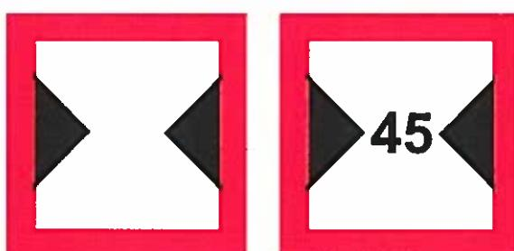
Примечание: На сигнальных знаках С.1, С.2 и С.3 могут быть также нанесены цифры. Соответственно указывают в метрах глубину, свободную высоту над уровнем воды и ширину фарватера или прохода.
