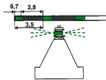
Сигнальные знаки А.2 служат для обозначения границ фарватера, а также для указания направления; они ограждают левую сторону фарватера и опасности левого берега реки.
