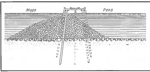
Поперечный разрез временной дамбы
