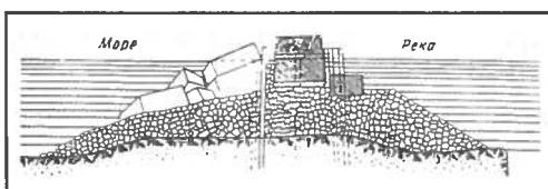
Поперечный разрез временной дамбы, превращенной в постоянную
