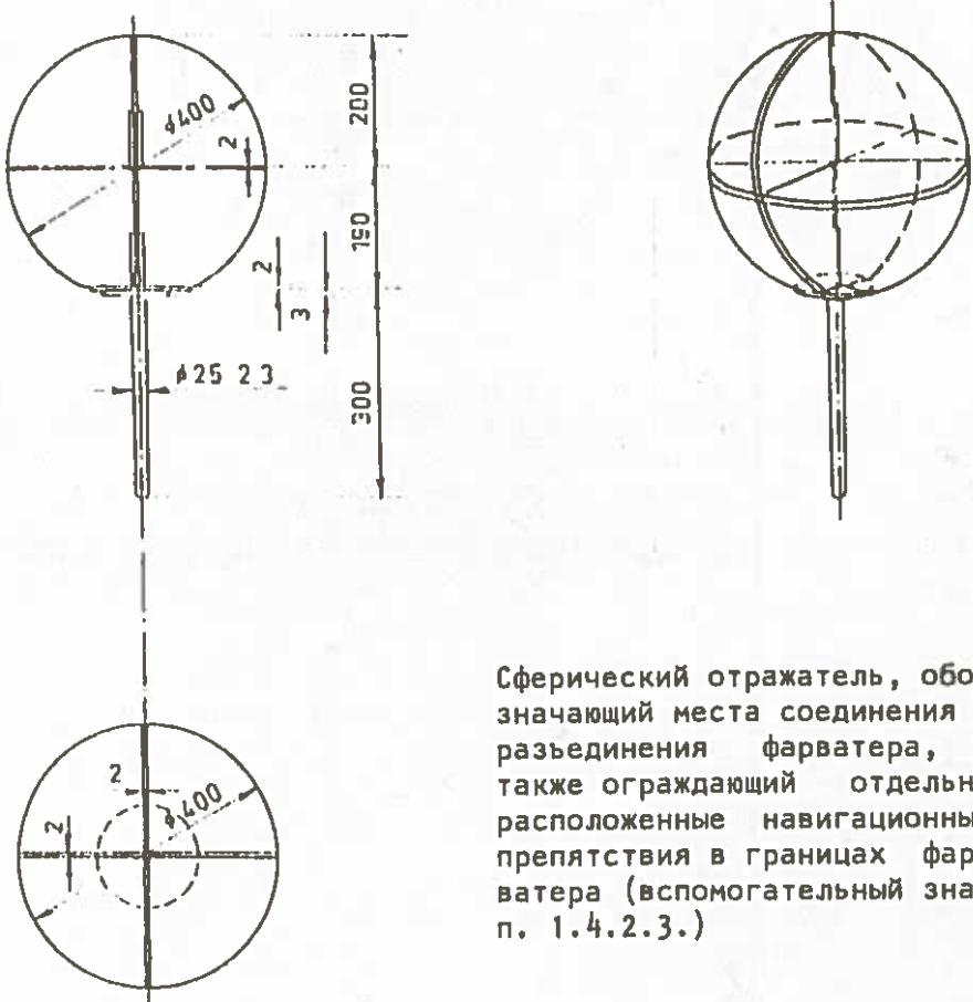
Сферический отражатель, обозначающий места соединения и разъединения фарватера, а также ограждающий отдельно расположенные навигационные препятствия в границах фарватера (вспомогательный знак п. 1.4.2.3.)
